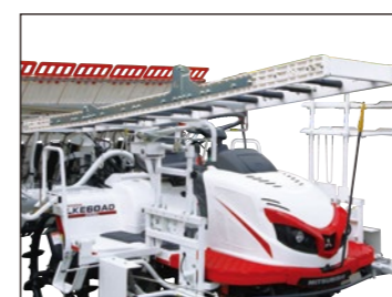
右側苗スライダー (KLE6-NKR-2) ※左側は紙カッターバーがあるため装着できません。
